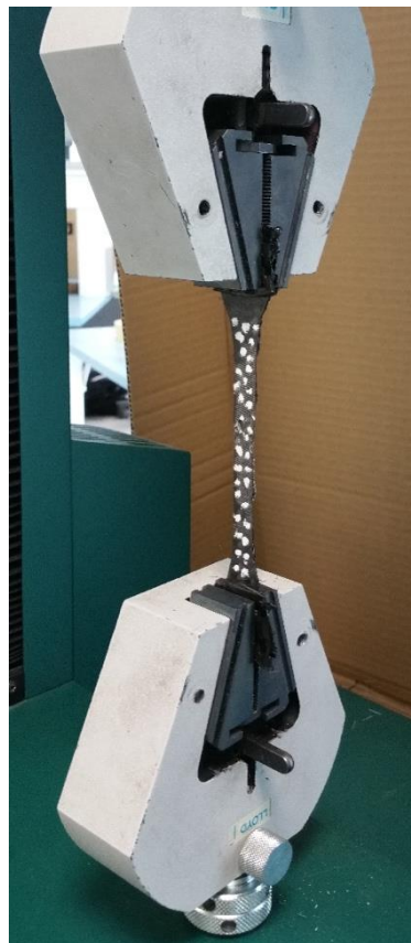
Figur 16: Merket strekkprøve i testmaskin 1
