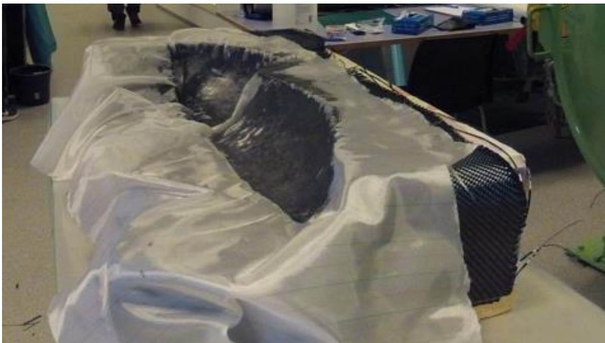
Figur 27 - Liten støpeform med peel ply
