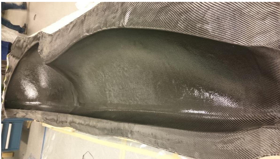
Figur 53 - Støpeform med karbonfiberduk mettet med epoxy
