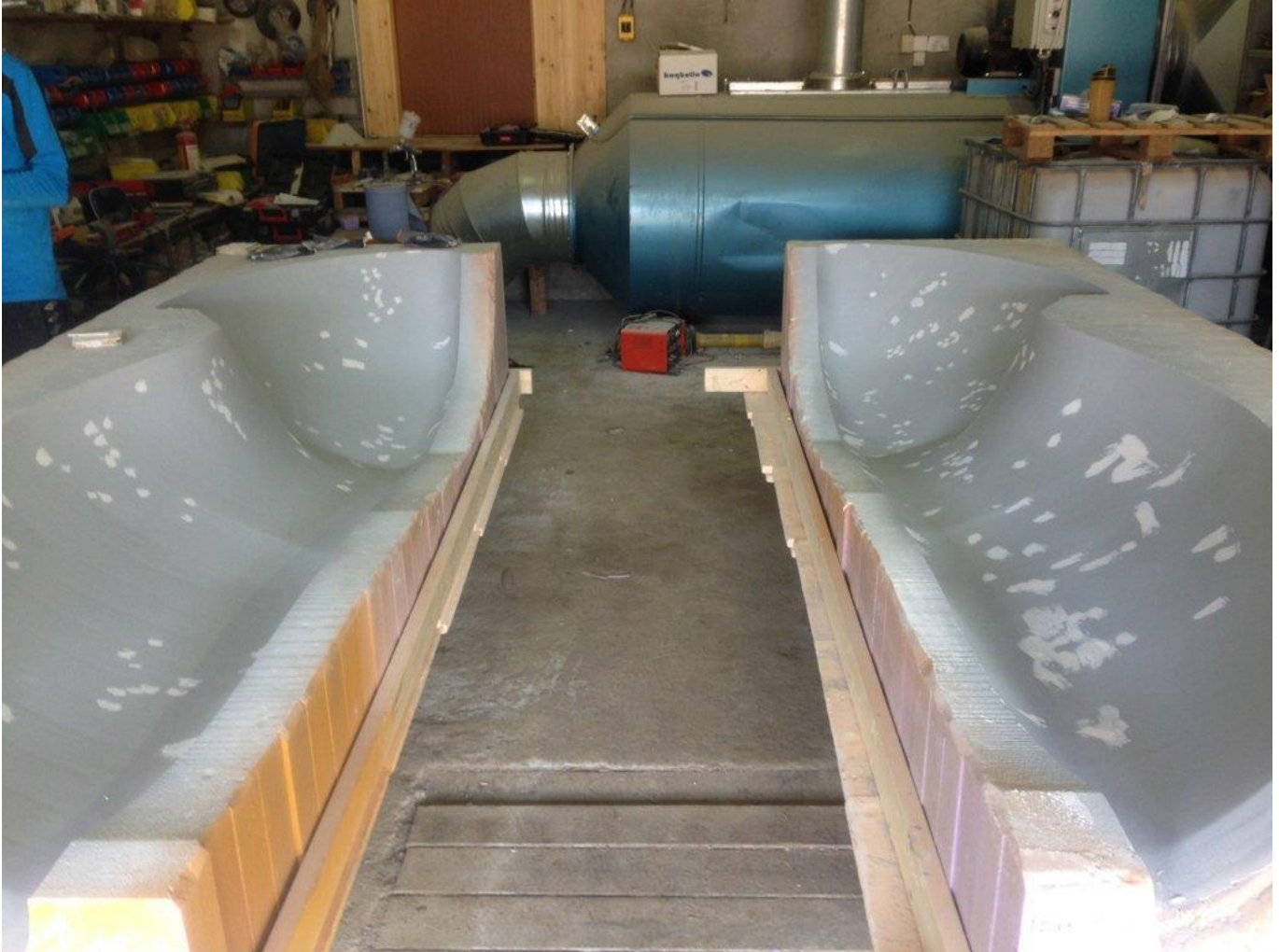
Figur 46 – Fjerde og siste gang med punktparkling på støpeformene
