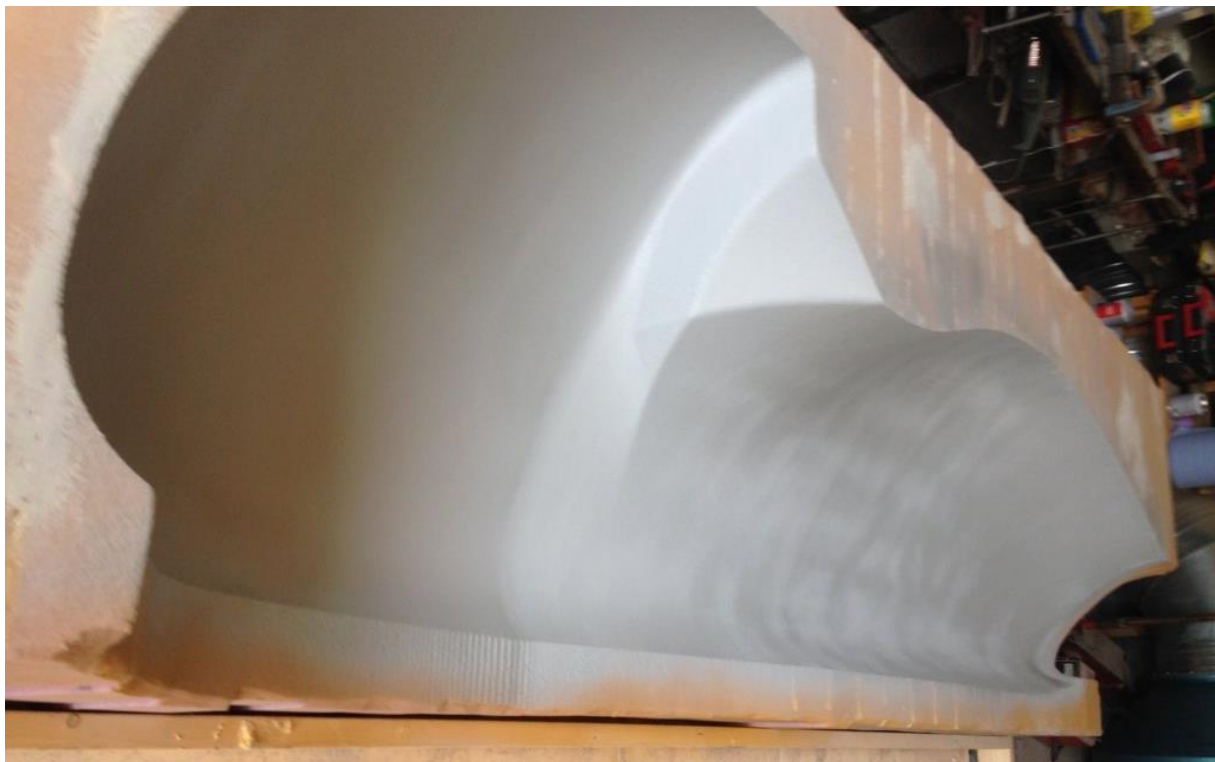
Figur 43 - Støpeform pusset og sprayet med spraysparkel
