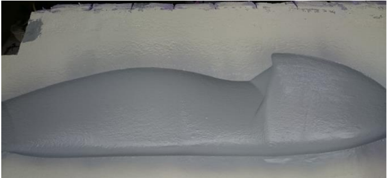
Figur 20 - Liten støpeform med sprøytesparkel påført med lakkpistol
