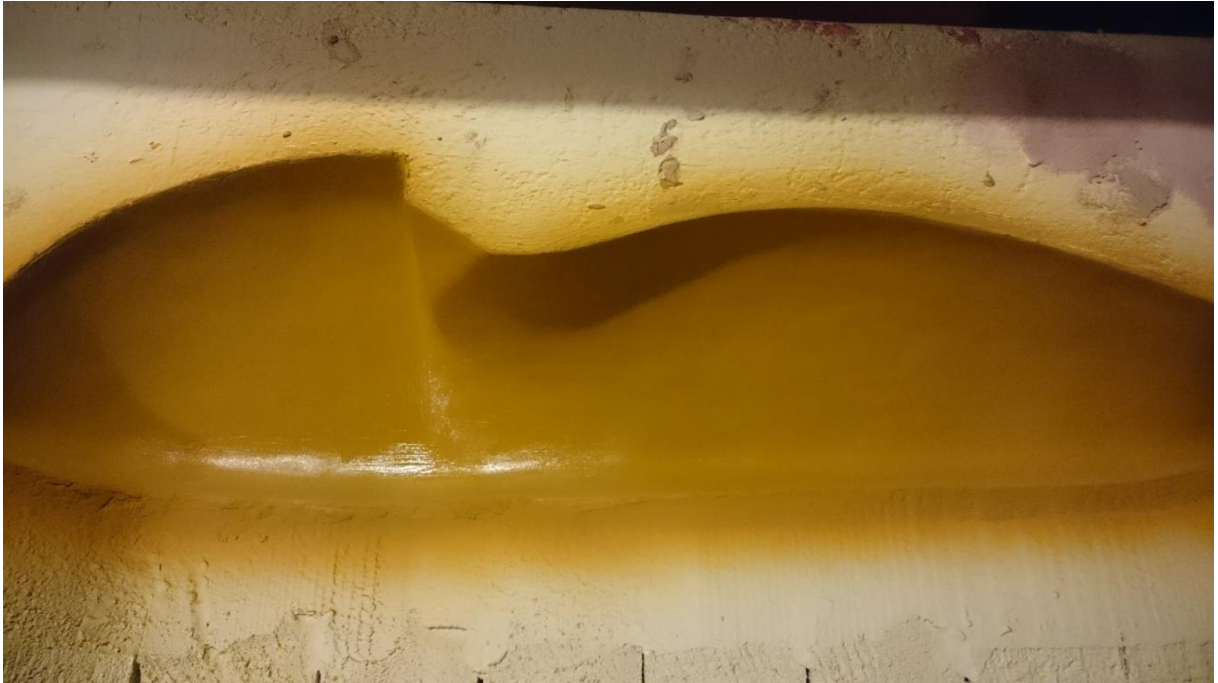
Figur 17 - Liten støpeform påført epoxy-primer
