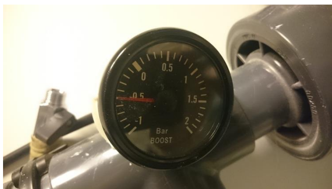
Figur 61 - Viser undertrykket vi hadde formene i over natten
