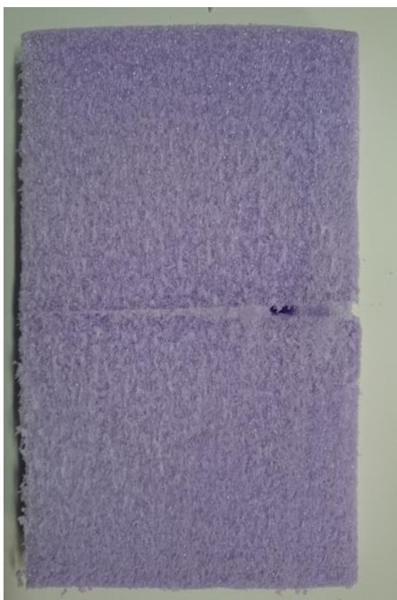
Figur 6 - Test 1, polyurethane trelim med polystyren-støv
