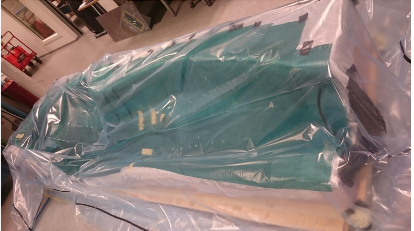
Figur 57 - Støpeform i vakuumpose
