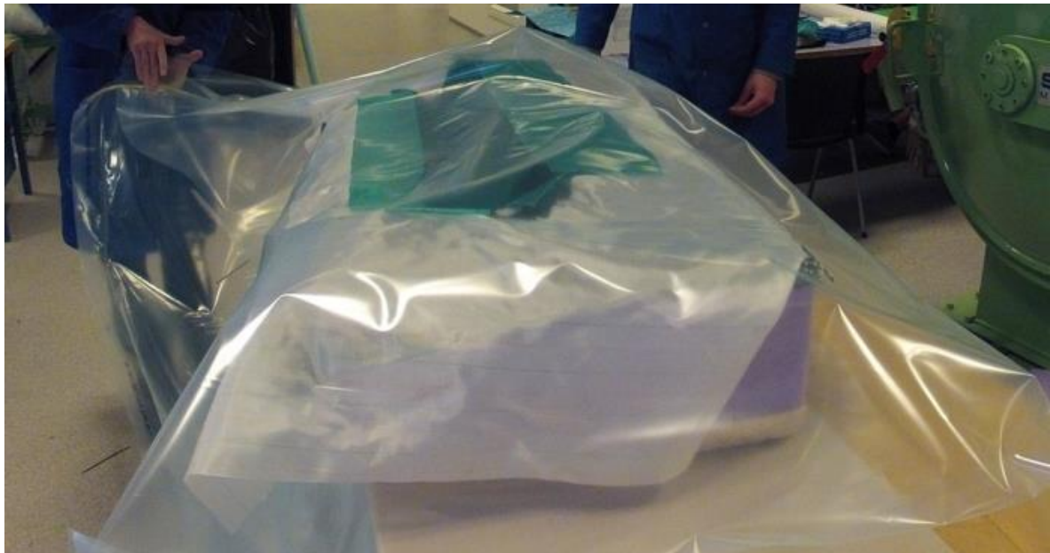
Figur 30 - Liten form med støp inni vakuumpose
