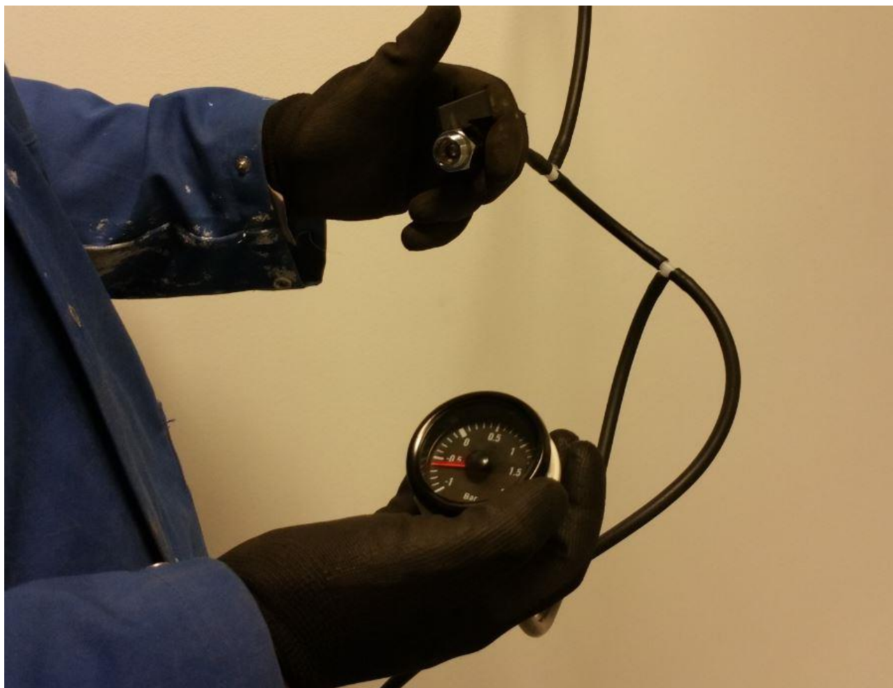
Figur 59 - Viser utløpet av luft og trykkmåleren vi brukte til å endre undertrykket
