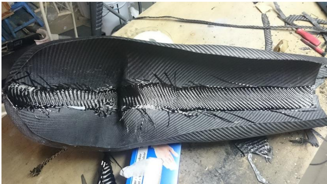
Figur 35 - Viser lite karosseri sammensatt av en stripe med karbonfiberduk
