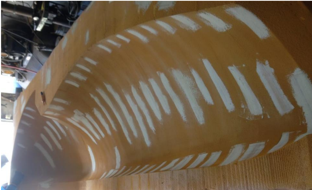
Figur 42 - Støpeform med første lag punktsparkling
