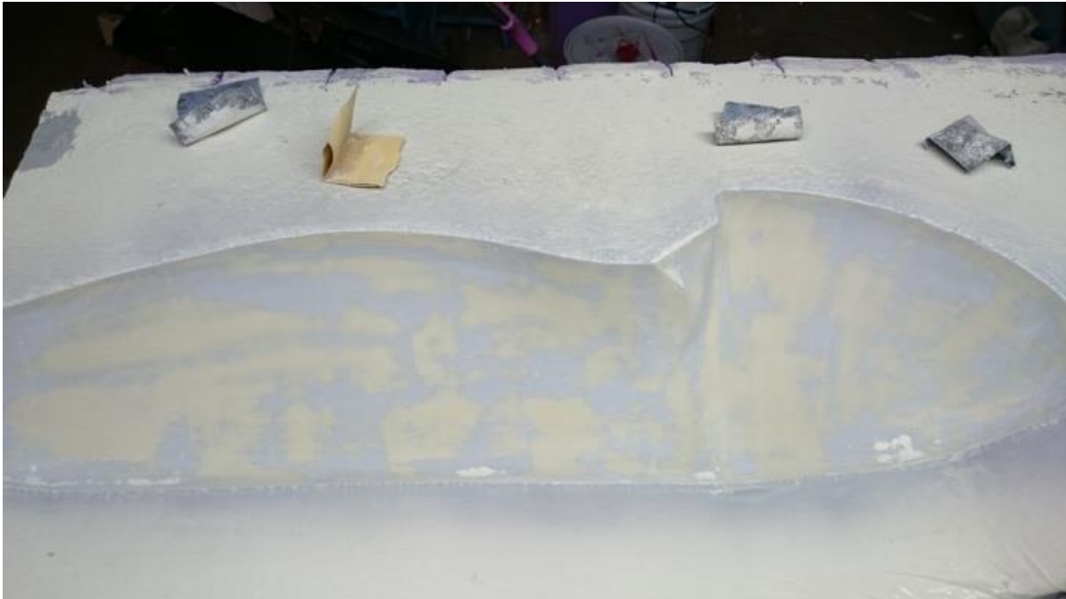
Figur 22 - Liten støpeform ferdig pusset etter påført spraysparkel
