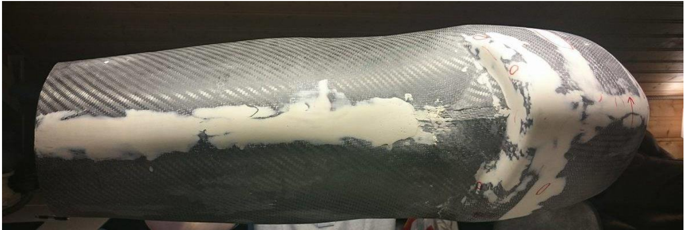
Figur 36 - Lite karosseri jevnet ut med sparkel
