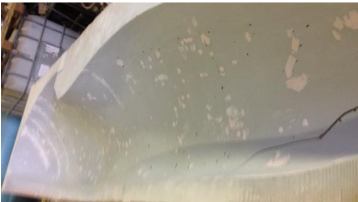
Figur 45 - 3. gang med punktsparkling på støpeform
