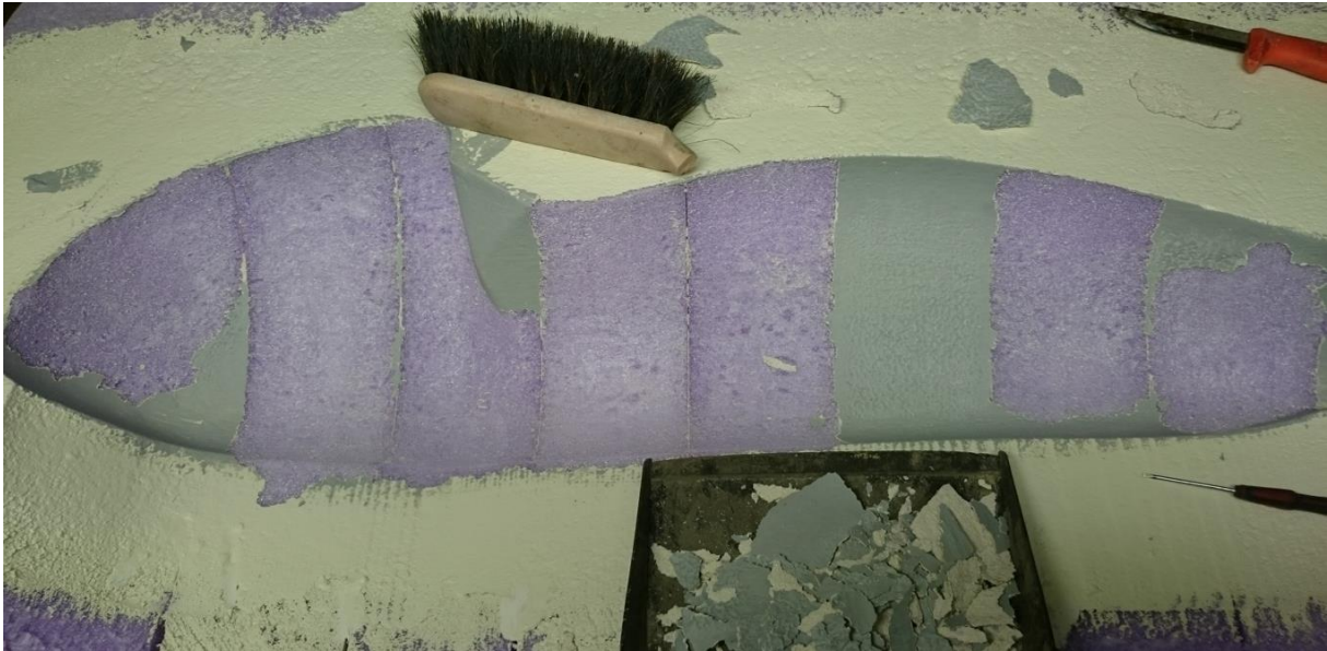
Figur 15 - Liten støpeform etter å ha plukket av lakk og sparkel
