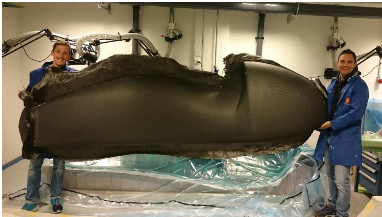
Figur 8 - Halve karosseriet ferdig støpt
