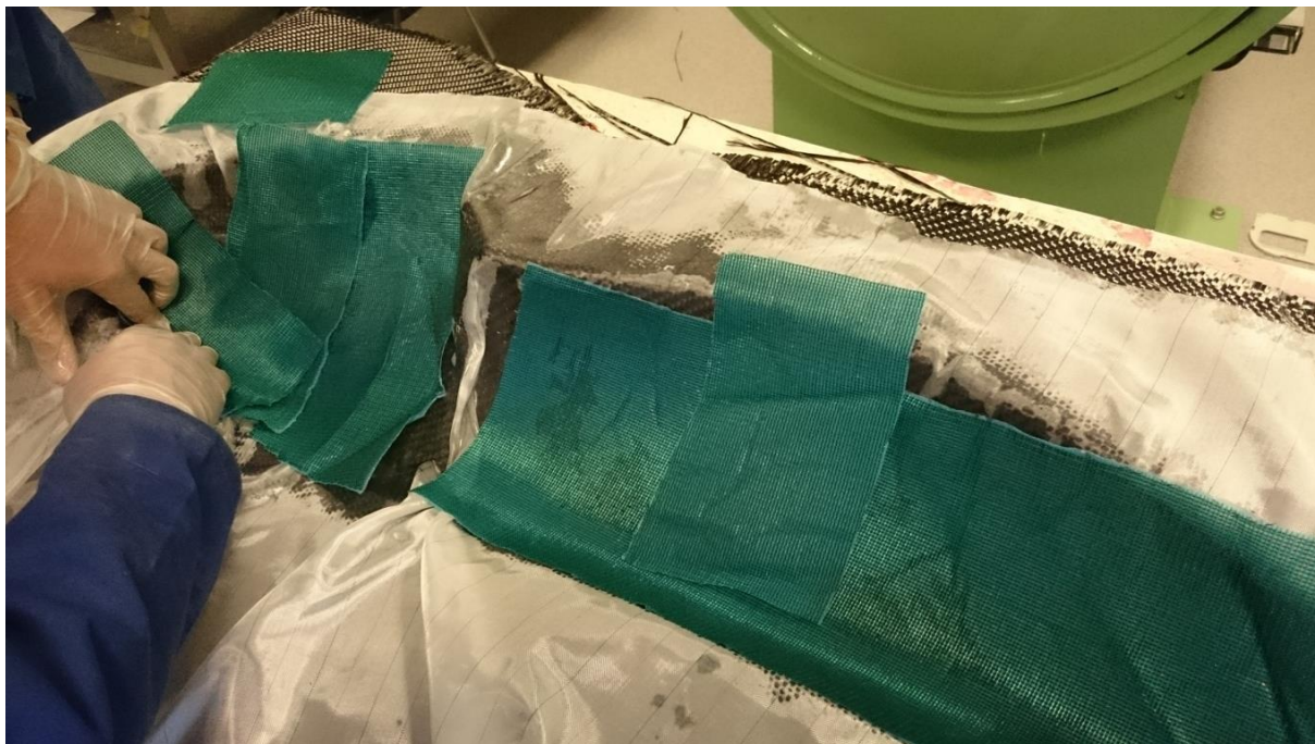
Figur 28 - Montering av nett med pin pricht
