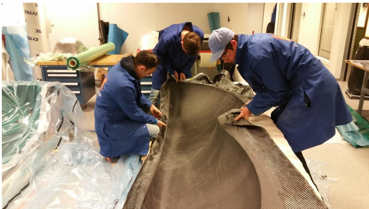
Figur 64 - Jobbing for å få støpet til å løsne fra støpeform
