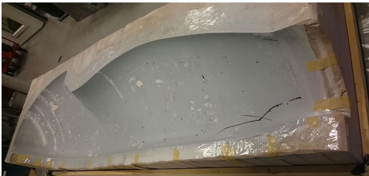
Figur 48 - Støpeform ferdig teipet og klar til støp
