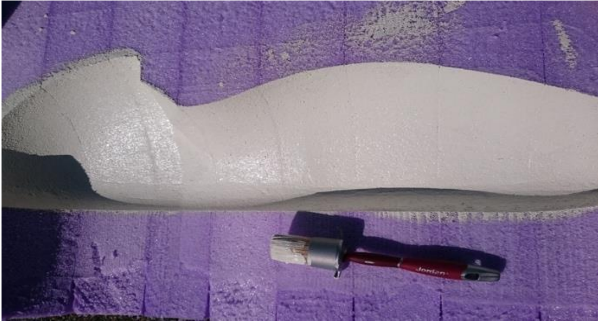
Figur 13 - Liten støpeform med penslet polyuretanlakk
