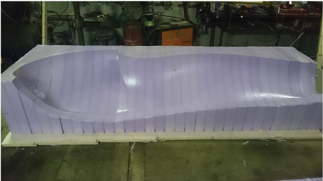
Figur 38 - Støpeform penslet med epoxy
