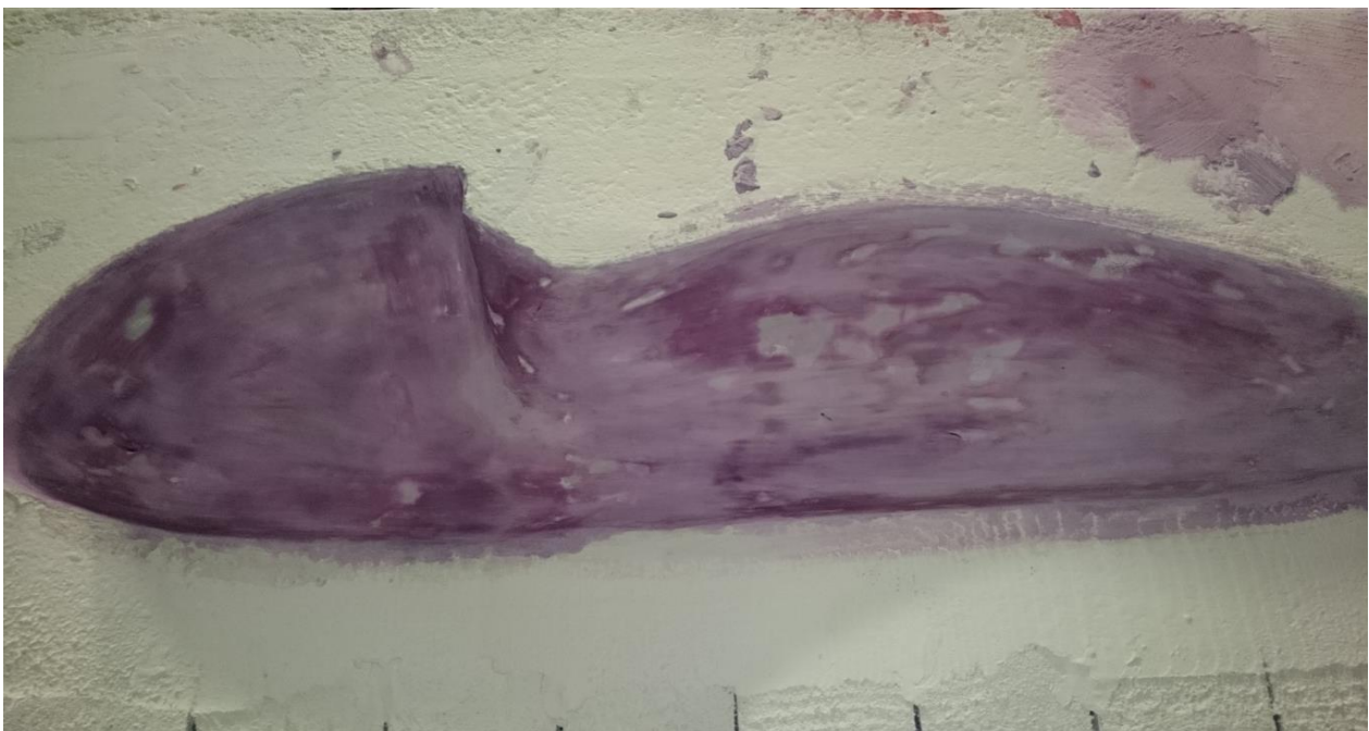
Figur 16 - Liten støpeform påført flere lag med gips
