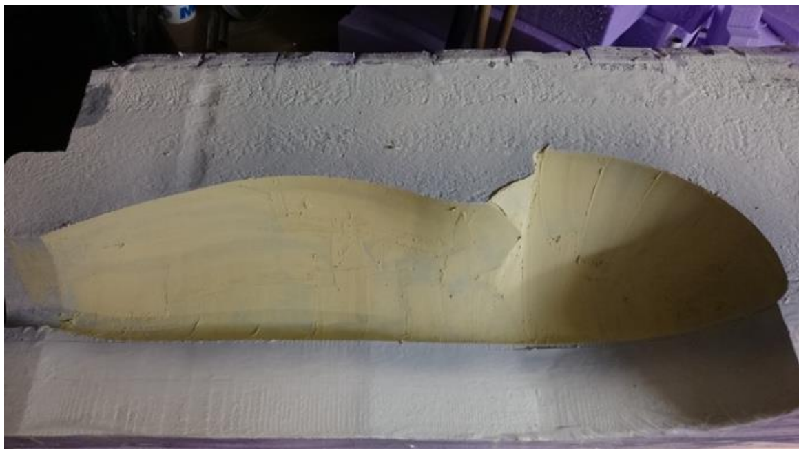
Figur 21 - Liten støpeform med standardsparkel
