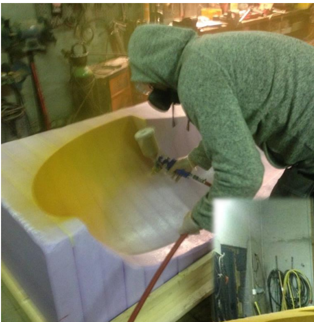
Figur 40 - Påføring av epoxy-primer
