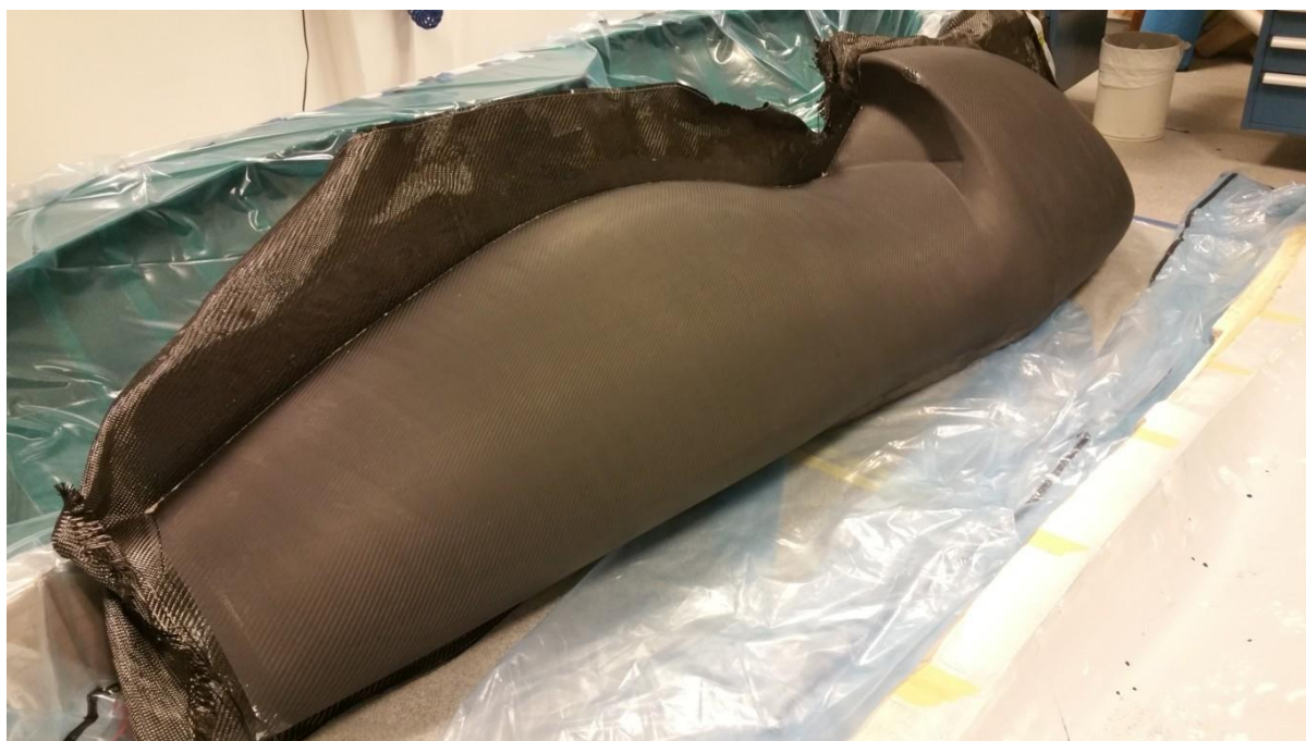
Figur 65 - Ferdig støp rett fra støpeform
