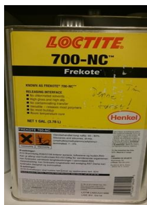
Figur 25 - Slippmiddelet som ble brukt
