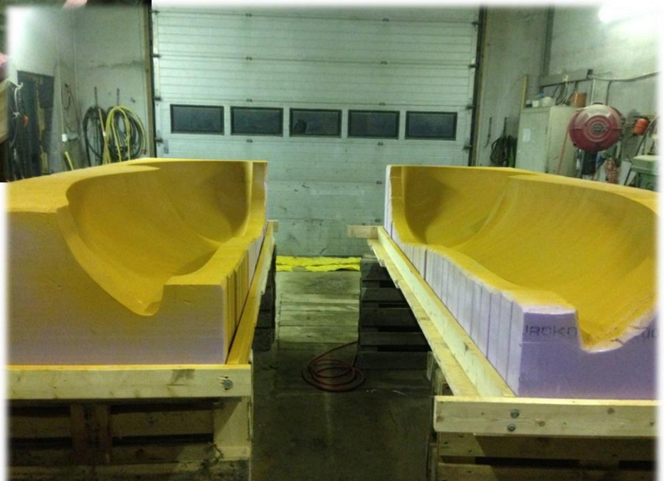
Figur 41 - Støpeformene ferdig sprayet med epoxy-primer
