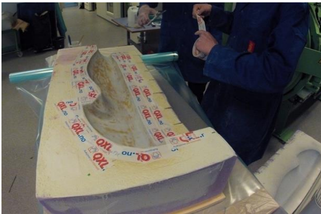
Figur 23 - Liten støpeform ferdig teipet og klar til støping
