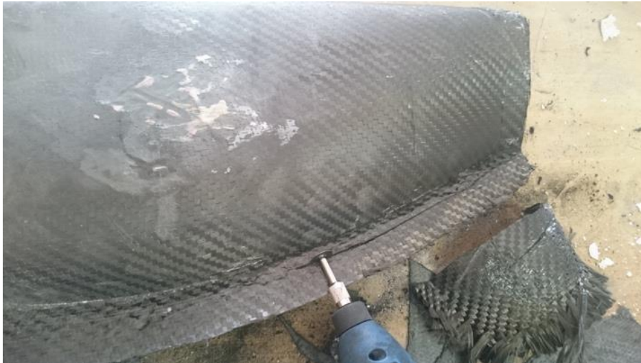
Figur 34 - Bruk av dremmel for fjerning av materiale
