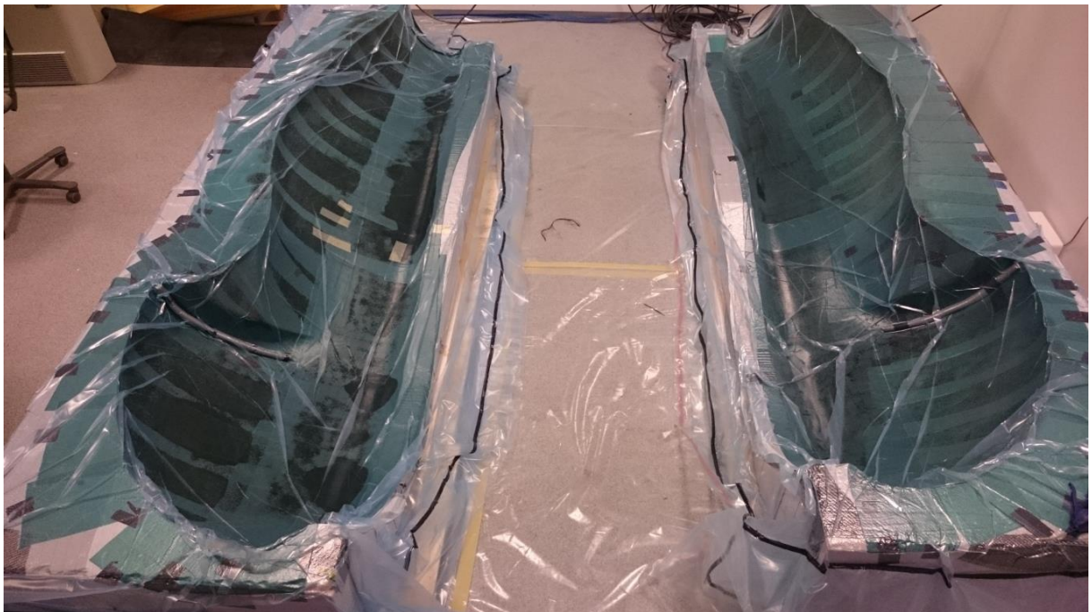
Figur 62 - Støpeformene med ferdig støp og vakuum, klare til herding over natten
