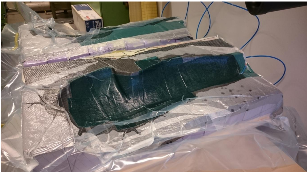
Figur 31 - Små formene i vakuum på - 0.9bar
