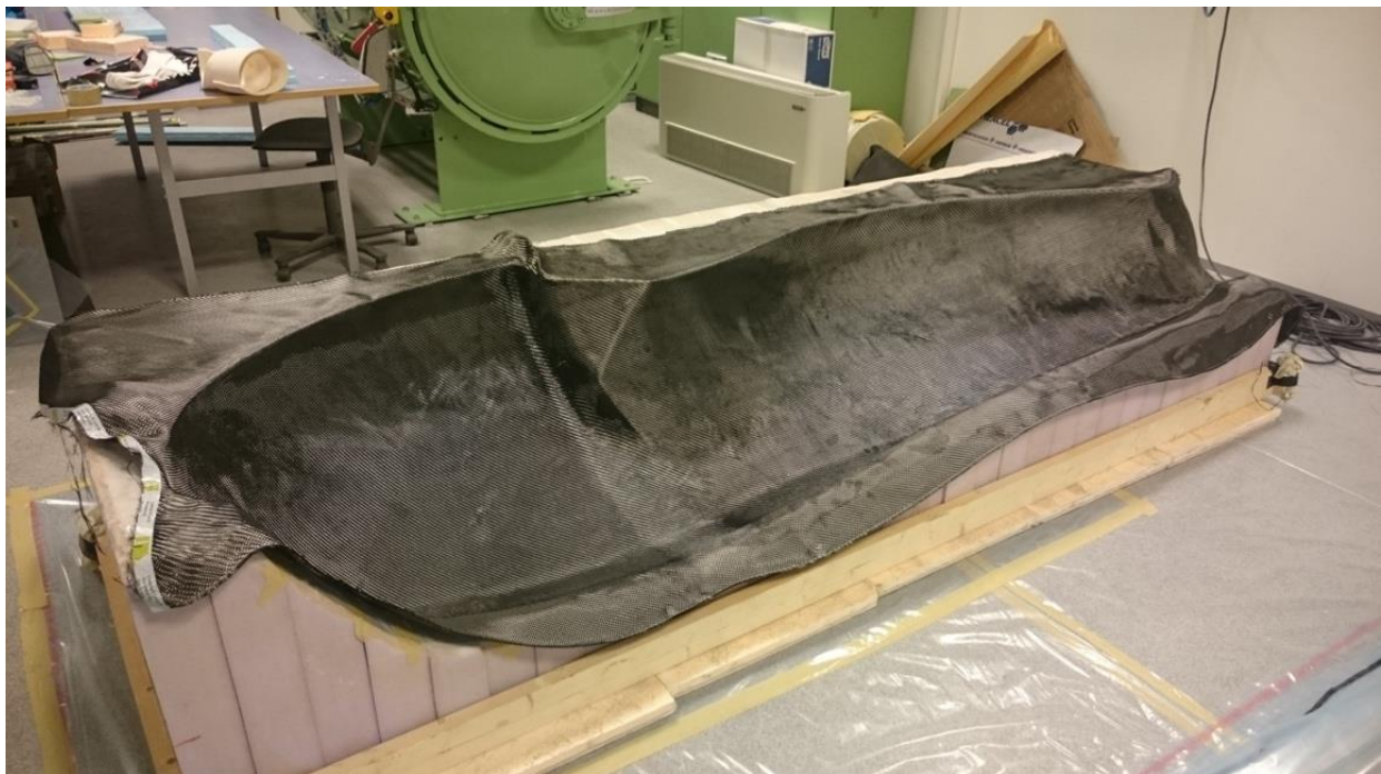
Figur 52 - Støpeform med karbonfiberduk oppi
