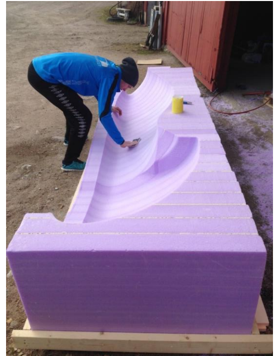
Figur 37 - Rolig pussing av støpeform
