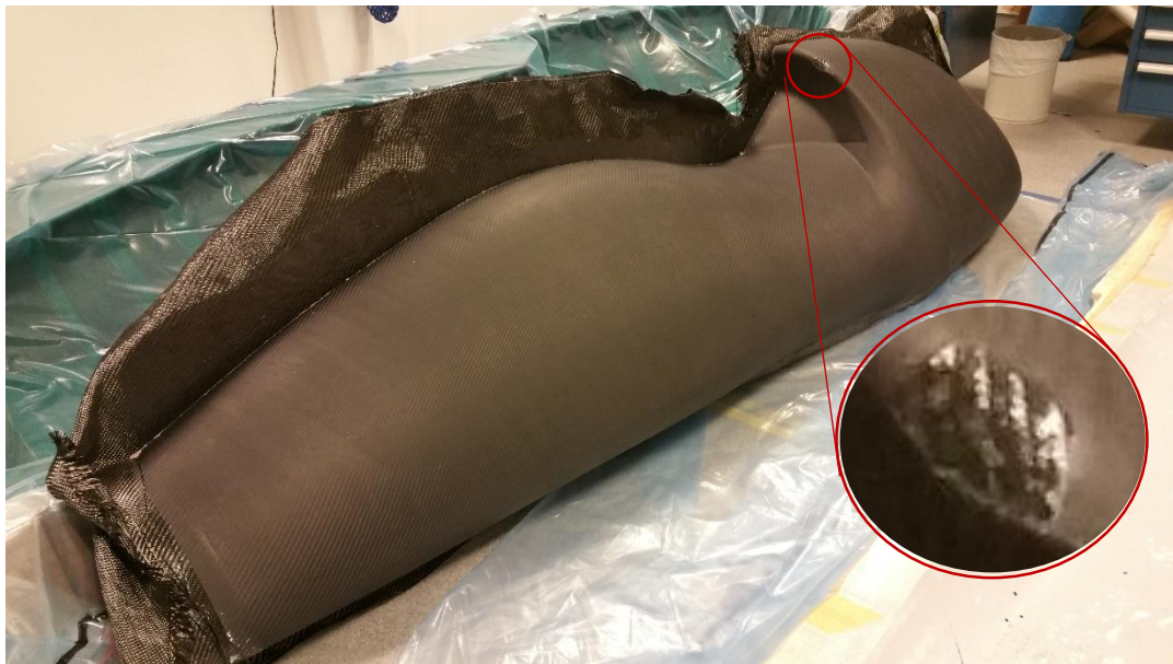
Figur 69 – Produksjonsfeil ved kjerv
