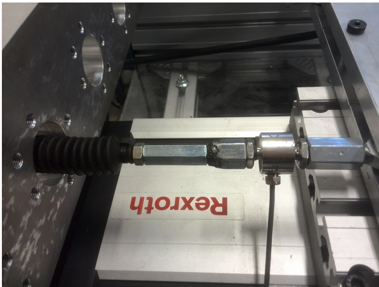
Figur 36: Lastcelle festet til rigg og kabel fra girspaken
