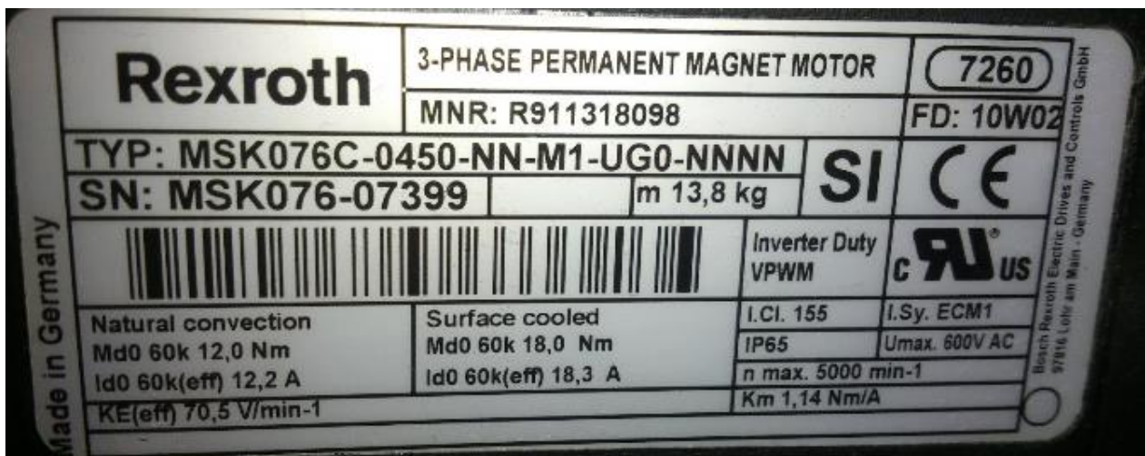
Figur 44: Deklarasjonsmerke på KA's servomotor
