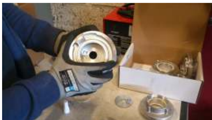
Bilde 1 - viser restriktorene som ble laget ved at en aluminiums skive ble sammenføyd imellom to Storz kuplinger med innvendig og utvendig gjenge.
