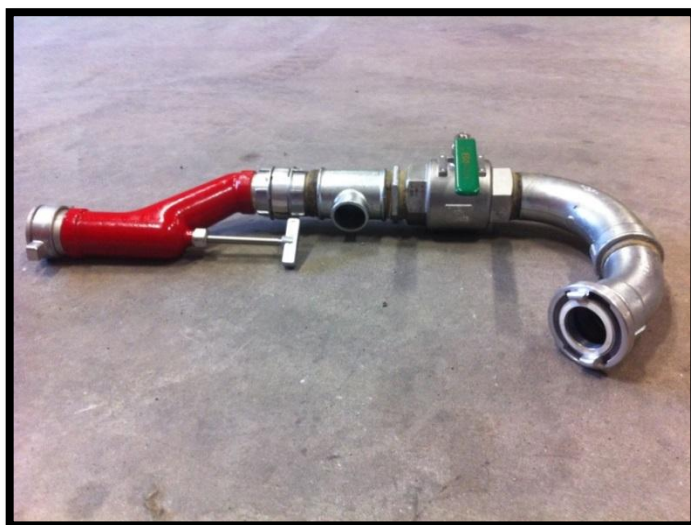
Bilde 8: Utspylingsdel – Enkel brannstender med 3" galv. rørdeler
