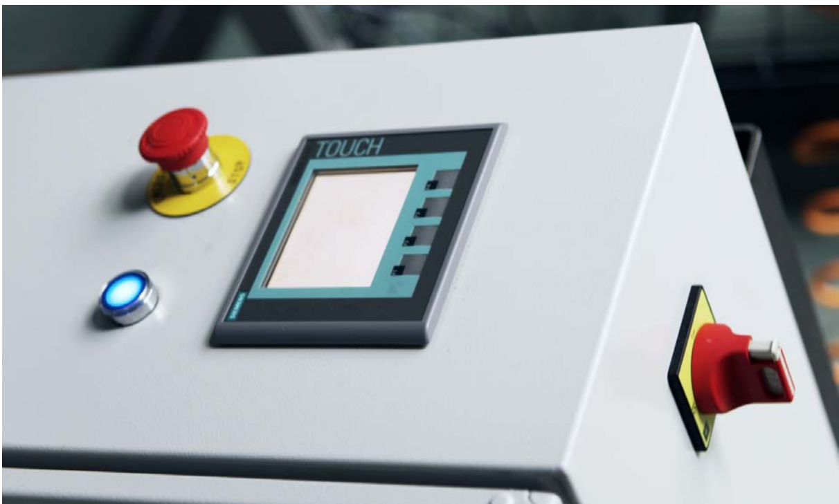
Figur 2: Kontrollpanel, nødstop, reset og bryter til strøm.
