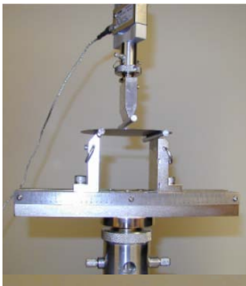
Figur 7, Til venstre, en tre-punkts bøyingstest [7], til høyre en flerakset bøyingstest.
