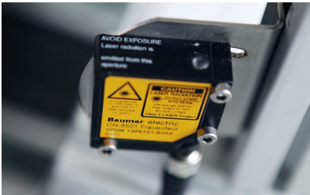
Figur 37, Nærbilde av laser som brukes i kalibreringen av heisen.
