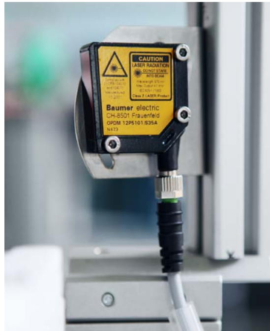
Figur 3, Laser for justering av høyde til heis.
