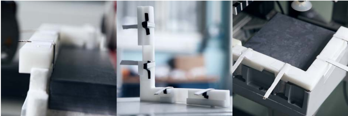
Figur 18, Braketten som skal holde de øverste waferer på plass.
