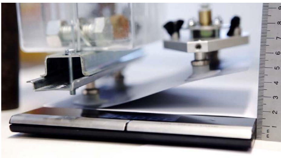
Figur 2, Testtrigen som ble brukt for å bestemme knekkhøyden og løftekraften.
