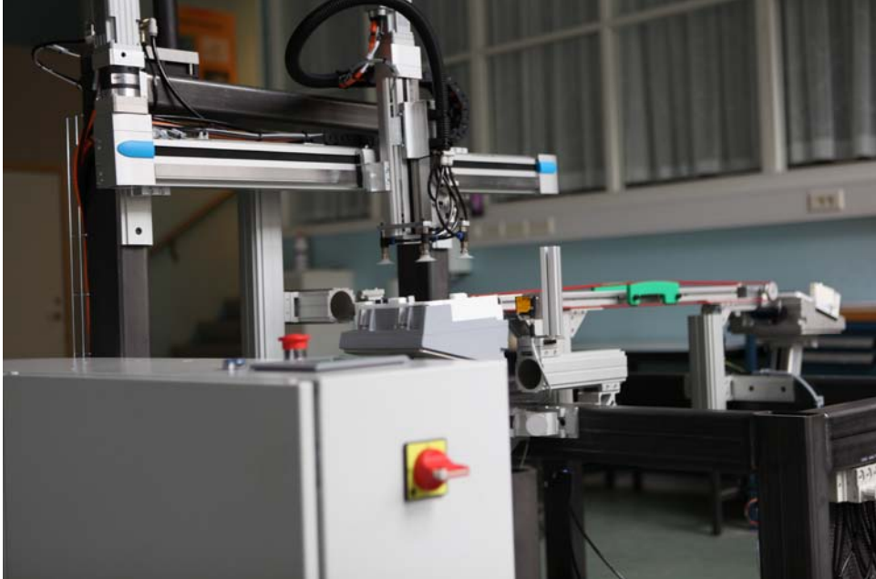
Figur 2 - Bildet viser utgangspunktet ved oppstart av systemet. Horisontal servoakse , vertikal servoakse og heis står her i initial posisjon.
