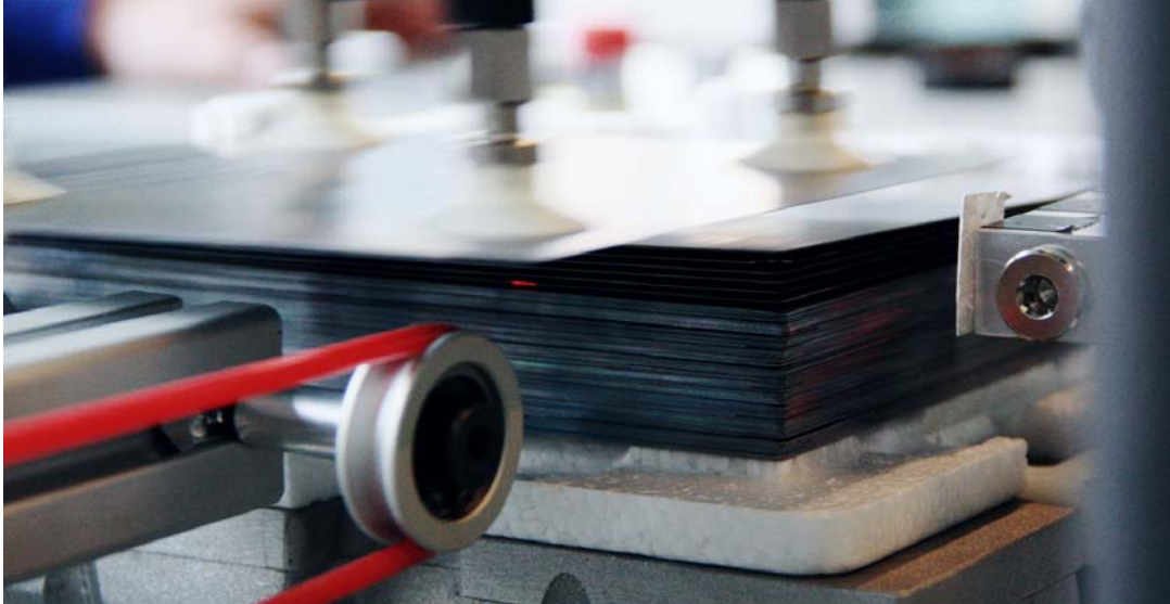
Figur 23: Bildet viser wafere som er separert av luften på toppen av bunken.
