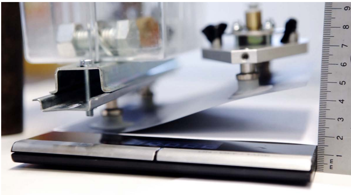
Figur 13, Bildet viser en wafer i bøyingstesten. Waferen er her løftet 33 mm.
