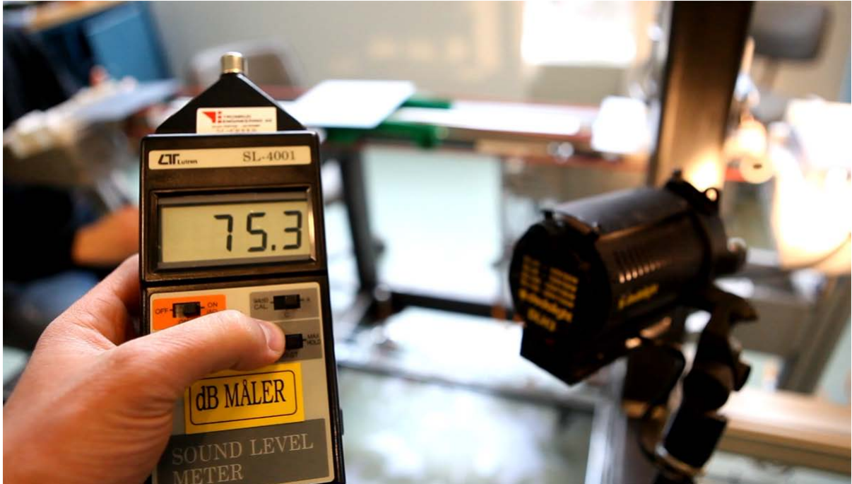
Figur 20, Måling av DB-nivå. Gjennomsnittlig registrert DB-nivå er 75.3 DB.
