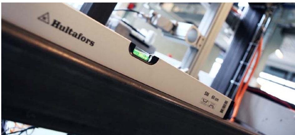
Figur 9, Vatring av prototype og klargjøring til testing
