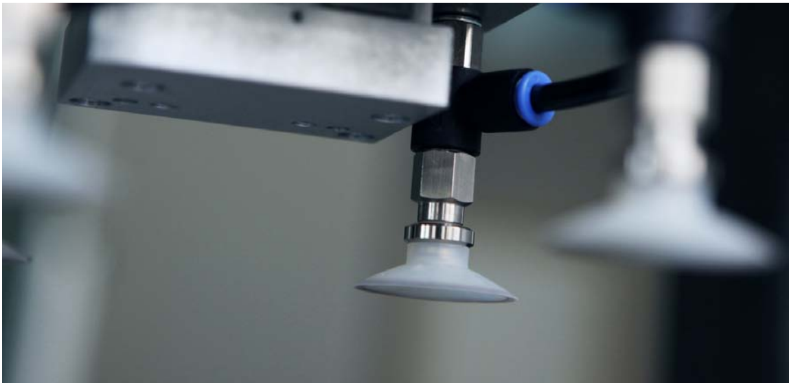
Figur 6, Nærbilde av sugekopp som blir brukt i gripper.
