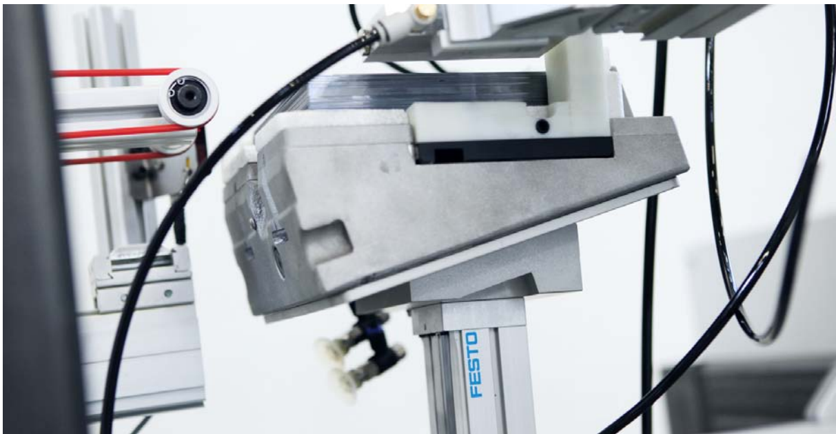
Figur 35, Bilde av heis nr 1 som sørger for at wafere holder seg i konstant høyde under opplasting.
