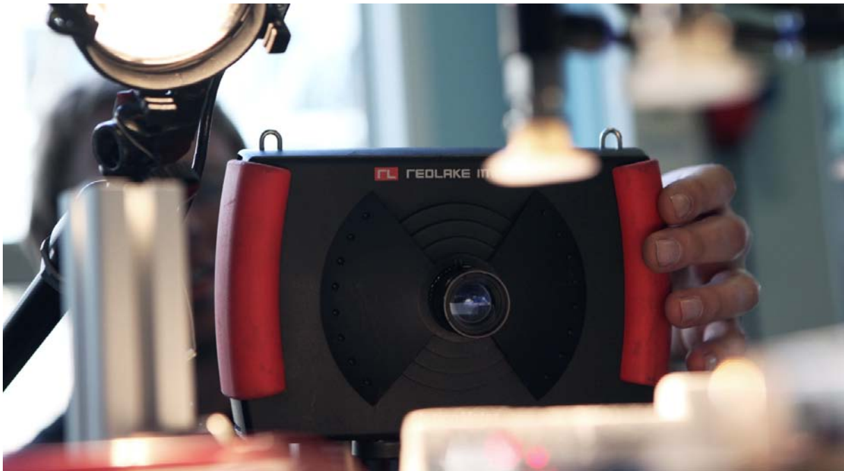
Figur 39, Høyhastighetskamera som ble brukt til den mest detaljerte og presise finstyring.
