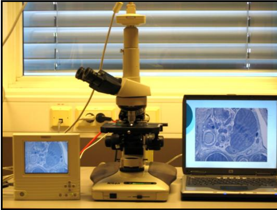
Figur 21 Bildet viser enheten for billedanalyse. Lysmikroskopet er koblet opp mot datamaskinen som har en enhet for lagring av bilder. Bildet blir prosjektert opp på den eksterne monitoren.
