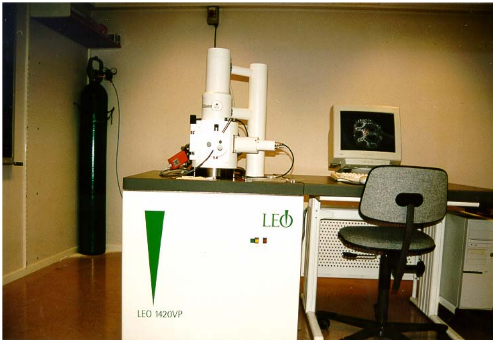
Figur 24. Bildet viser skanning elektronmikroskop med variable trykkmuligheter og TEM detektor.
