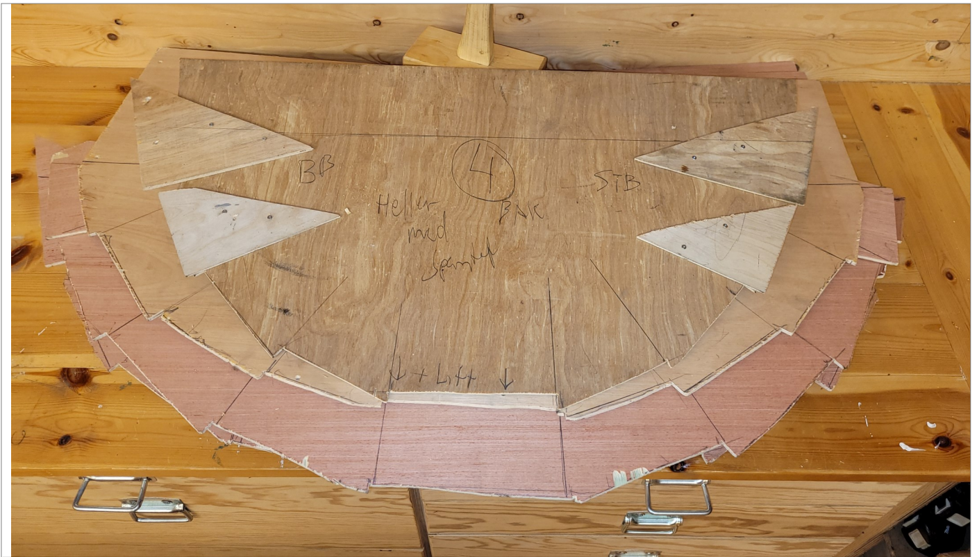
Fig 5. Ferdige modellspant. Plassering og orientering ble skrevet på. Øvst ble ripbordets øvre kant merket.
