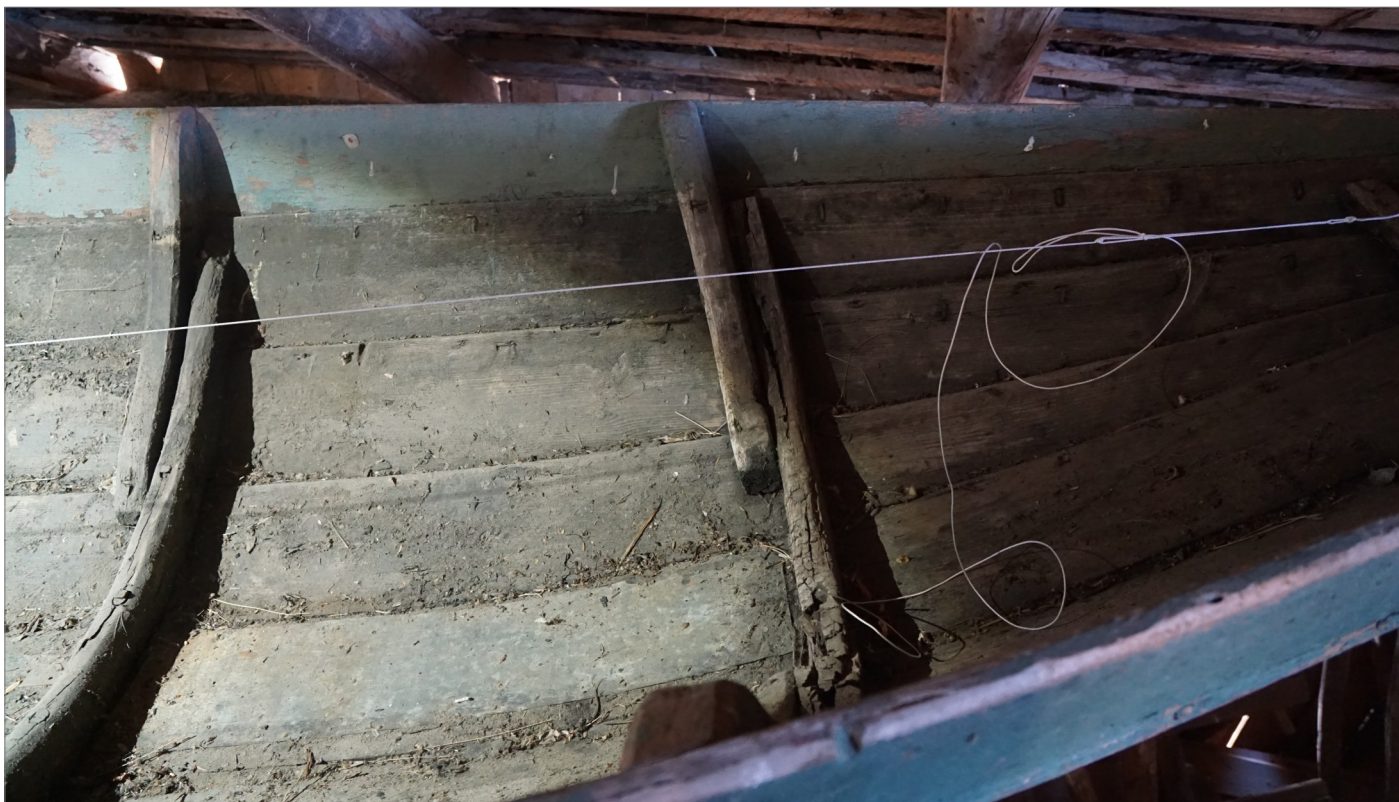
Fig 15. Nøkkinga vendte i hovudsak kroken nedover bordet. Den andre bordgangen på bb side hadde spor som tydet på at det kan ha vært et gjenbrukt takbord. Opplengerene lå ikke konskvent helt parallellt med banda.
