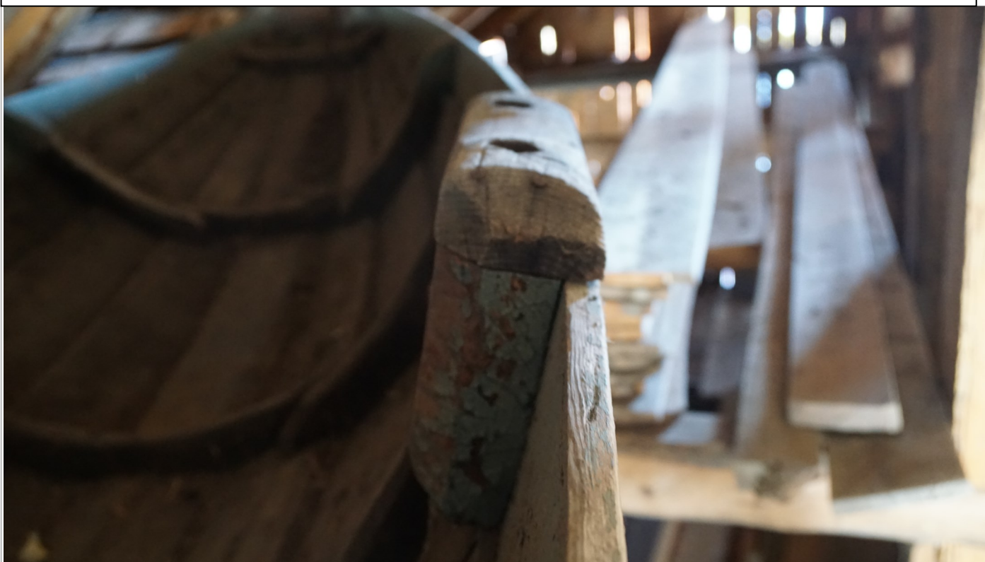
Fig 14. Ripbordet var ikke støttet av noen form for belistning i øvre kant. Tollegangens slidedel var laget i eik. Den lå utover ripbordet og hindret gnag.
