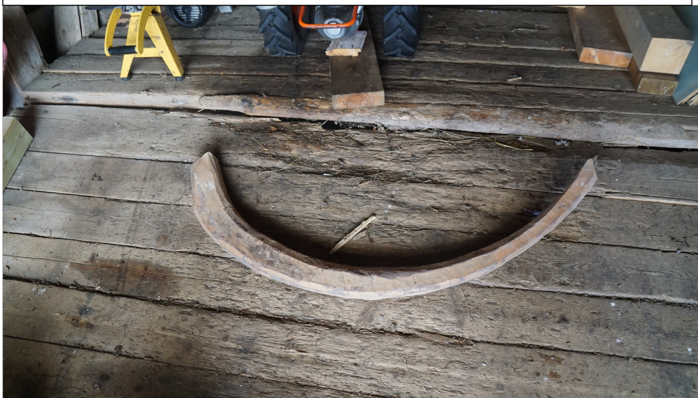
Fig. 18. Bandemnet som jeg også fant på låven var sidehugget til drøye 2 toms og laget av en greinkrok.
