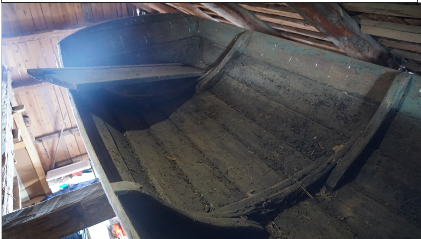
Fig 8. Bak i prammen. Akterspeil av to bord med fint avrundet overkant. Banda nr 2 bakfra var reparert. Banda er stod i hovudsak vinklet på prambordet. Det gjorde at at alle banda heller mot midten av båten.
