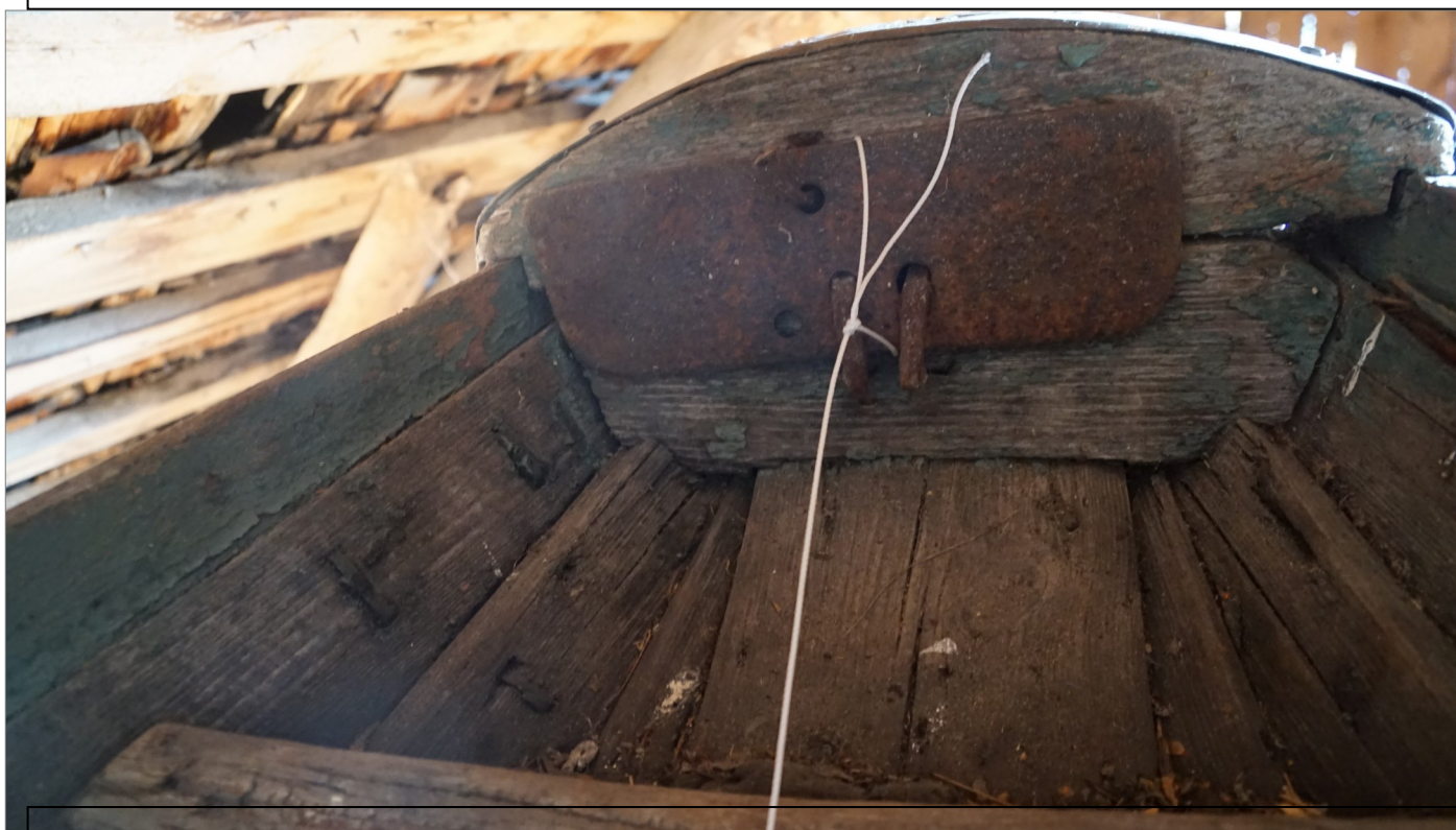
Fig 10. Framspeilet var ikke felt på plass med stor nøyaktighet. Det var heller ikke nødvendig når det aldri kom ned til vannflaten. De to første bordgangene gikk nesten ut i null i framkant av speilet. Det er de to siste bordgangene som bygde høyde. Framspeilet var delt ved overkant av tredje bordgang.
