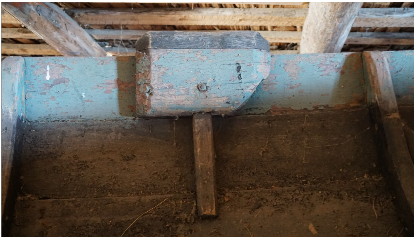
Fig. 13. Opplengerene var avsluttet i flukt med ripbordet. Både band og opplengere var uten dekor, men hadde faset kant. Tollegangen stod på stolpe og var festet med en bolt og med nøkkede spiker.
