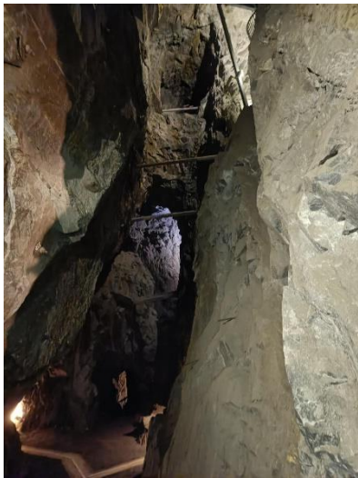
BILETE 4: VISER STROSSA I BESØKSRUTA. HER ER FJELLET HAKKETE, SOM TYDER AT DET ER BRUKA SPRENGSTOFF FOR Å FÅ UT MASSEN.
