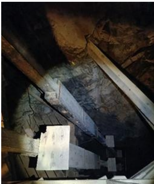
BILETE 1: BILETE VISER KORLEIS FAHRKUNSTEN SER UT I DAG. GUIDEN DEMONSTRERER HEISEN VED Å GÅ UTPÅ DET ØVSTE BRETTET. HEN BLIR DÅ FRAKTA VIDARE NEDOVER VED Å GÅ OVER PÅ DET NESTE BRETTET NÅR EIN MØTER DET. ORIGINALT GJEKK DENNE 300 METER NED. HEISEN VISER HØGDENE I GRUVA.
