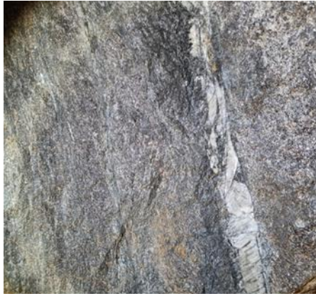
BILETE 2: BILETE VISER EIN SØLVHOLDIG KALKSPATÅRE SOM FINN STAD I BESØKSOMRÅDET I KONGENS GRUVE. DEN KVITE ÅRA MED STEIN ER KALKSPAT, OG DU KAN SJÅ ANTYDING TIL RUST SOM ER FAHLBÅND. SØLVET ER SÅ LITE AT DET ER VANSKELEG Å SJÅ.
