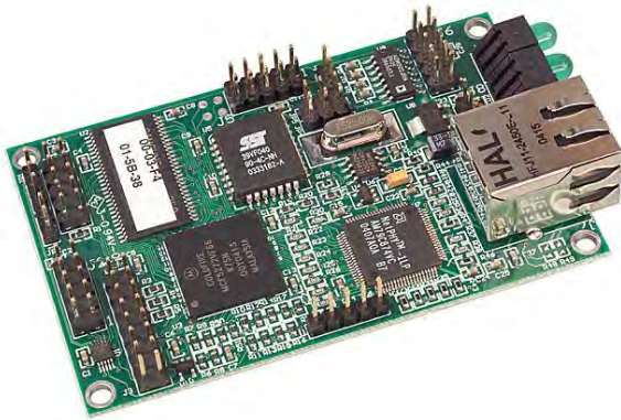
Figur 2.14 Et maskinkort med flere mikroprosessorer ( http://parts.digikey.com/1/parts-kws/index1003.html )
