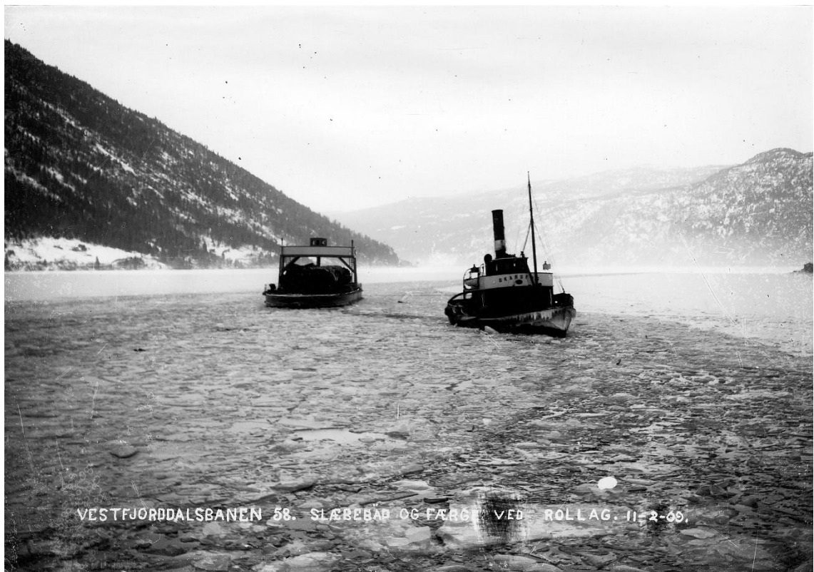
Figur 11: M/S Skarsfos med slepebåt i februar 1909. M/S Skarsfos ble bygd i 1908 som taubåt for sleping av lektere over Tinnsjø og som isbryter. Den har typisk isbryterskrog, dyptgående og med skarp, knekket baug som gjør at båten hever seg opp på isen og knekker den ned under fart. Under den midlertidige driften fra 1. januar – 8. august 1909 ble det brukt en flatbunnet slepeferge av tre med spor og plass til 12 vogner. Isforholdene var svært vanskelige den vinteren. 62 Foto: Norsk Hydros fotosamling/NIA
