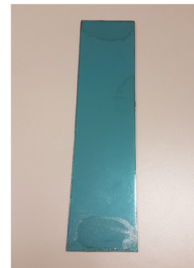
Dagslysmåling med lyseblått pleksiglass.
