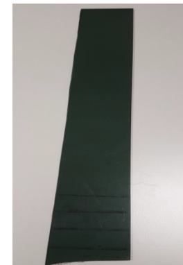
Dagslysmåling med grått plexiglass.
