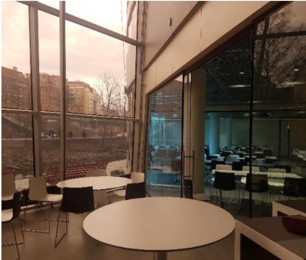
Figur 50: Akerselva Atrium oppleves fargegjengivelsen av interiøret, hudfargen til mennesker som lite naturlig og det meste blir brun- grått. Akerselva Atrium har gjennomgående glassfasade med Orange fargefilter
