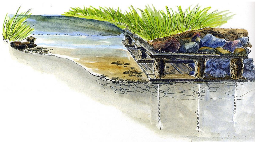
Figur 5. Eksempler på konstruksjon og plassering av en lunke (rugg) i elv 4 .
