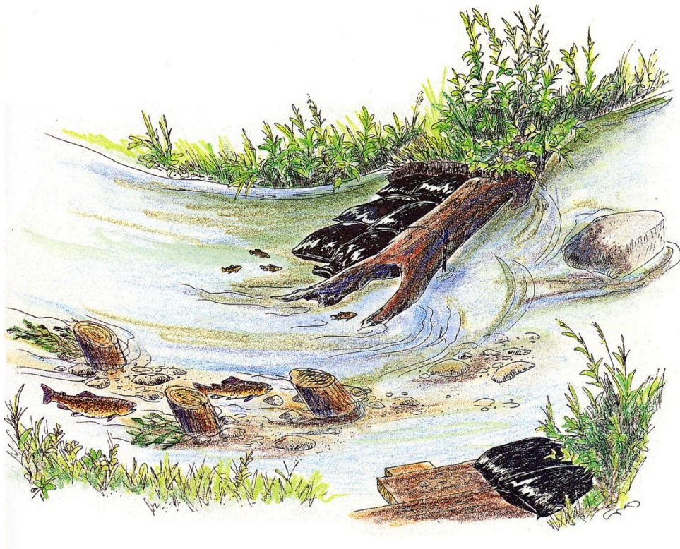
Figur 4. Eksempler på hvordan trestokker og trerøtter kan øke mangfoldet i strømhastigheter og dyp 4 .
