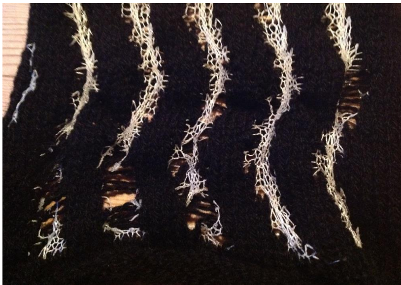
Figur 28: Forsvindingstråden tåler ikke vand (eget foto)
