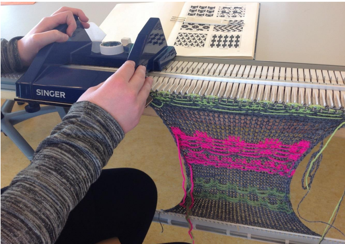
Figur 64: Da tråden er lagt, køres slæden over (eget foto)
