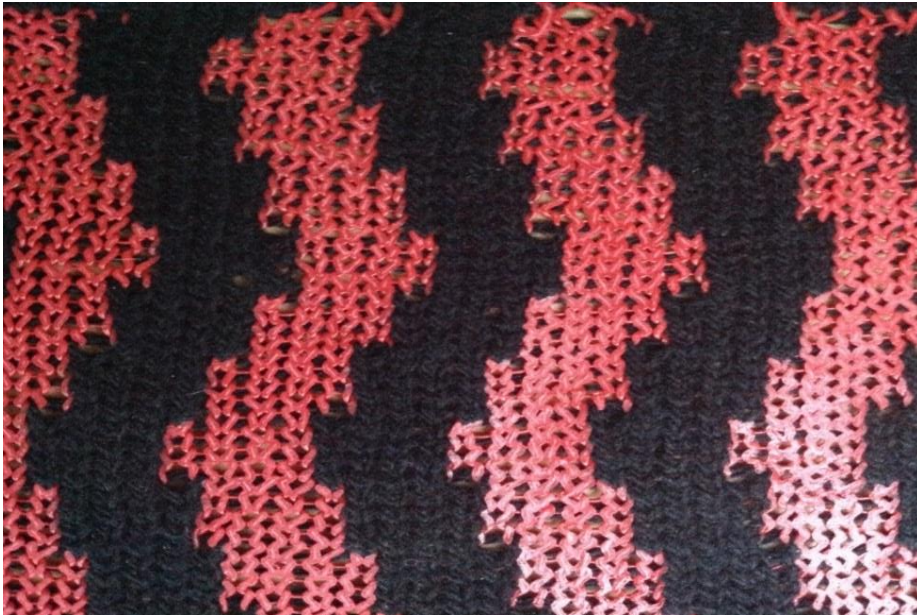
Figur 26: Man kan se at Rubcotråden er smeltet (eget foto)
