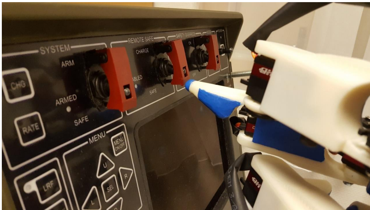
Figur 27: Indre bryter lukker seg sammen med ytre vippebryter.
