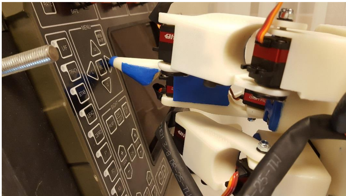
Figur 28: Ny fingertupp til EE fungerer som den skal og klarer å trykke inn knapper på DCP
