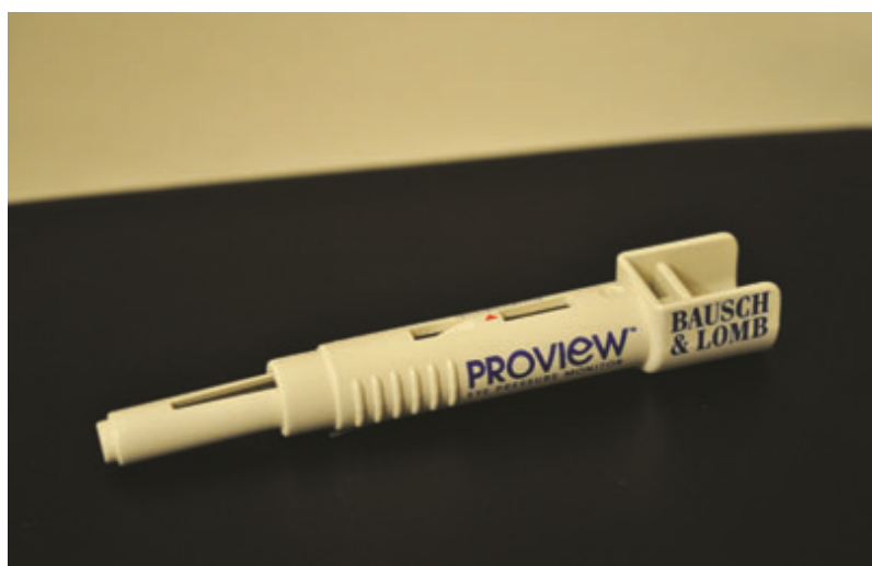
Figur 1. Proview Pressure Phosphene Tonometer (Bausch & Lomb.Inc.) Bildet viser tonometeret bestående av et fjærbelastet kontaktkon (venstre del på bildet), riller på siden for et godt grep, en skala i mmHg og en nullstillingsknapp. Tonometeret koster rundt 515 kr ( www.drugstore.com ) og er laget av lett plastmateriale. Instrumentet er 17 cm lang og veier 8 gram.
